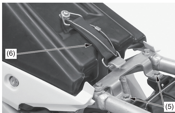
(5) bulloni di fissaggio del filtro dell'aria (6) fascia del serbatoio del carburante
