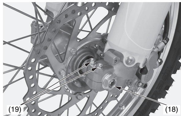
(18) dado dell'asse anteriore (19) bulloni di fissaggio perno ruota sinistro
