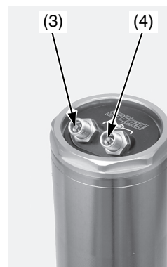
(3) valvola dell'aria della camera interna (4) valvola dell'aria della camera esterna (5) valvola dell'aria della camera di bilanciamento (6) elemento centrale della valvola dell'aria della camera di bilanciamento
