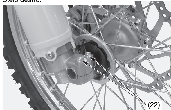
(22) bulloni di fissaggio perno ruota destro
