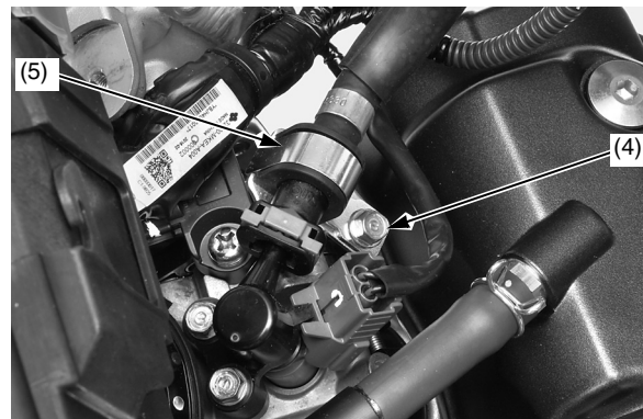
(4) bullone (5) morsetto e gommino di posizionamento
