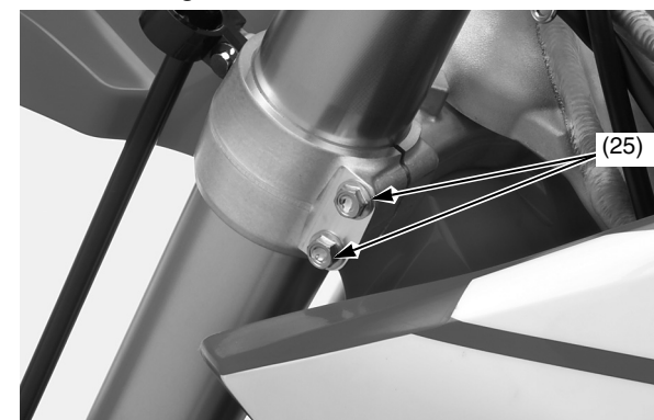
(25) bulloni di fissaggio inferiori del ponte della forcella
