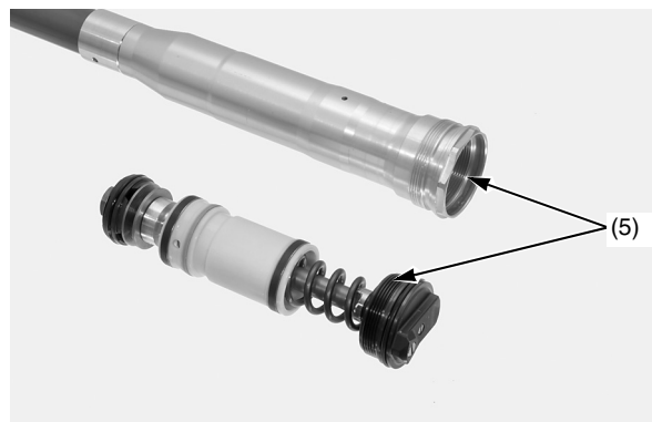
(5) filettature del bullone della forcella e del gruppo dell'ammortizzatore della forcella
