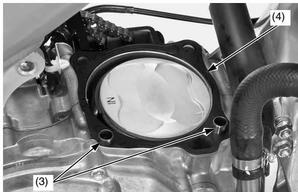
(3) perni di centraggio (4) guarnizione del cilindro
