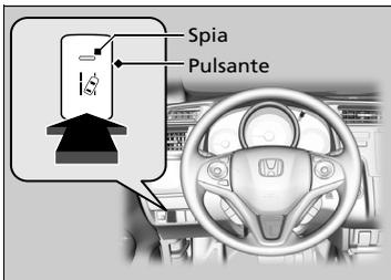
Premere il pulsante dell'avviso di allontanamento dalla corsia per attivare o disattivare il sistema.
