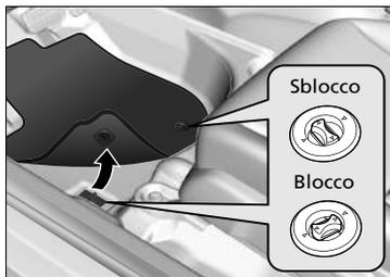
Il tappetino pianale lato guida si aggancia agli ancoraggi sul pianale e ciò ne impedisce lo spostamento in avanti. Per rimuovere un tappetino per la pulizia, ruotare la manopola di ancoraggio nella posizione di sblocco. Quando si riposiziona il tappetino dopo la pulizia, ruotare le manopole nella posizione di blocco.
