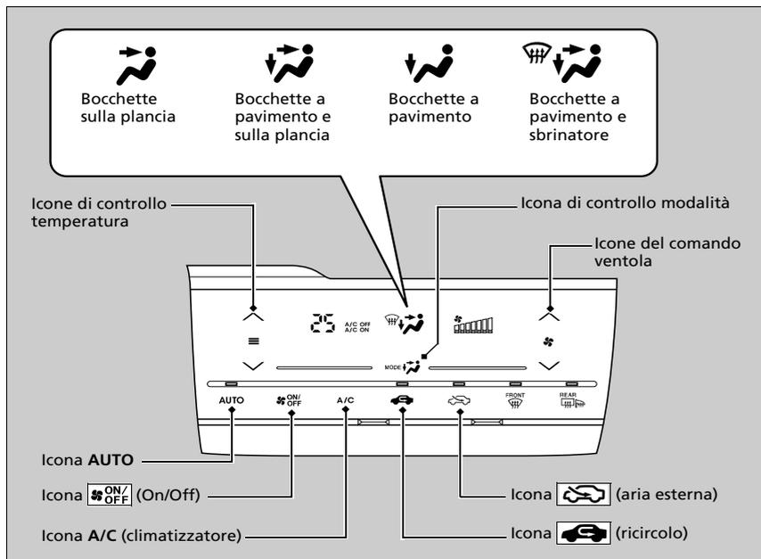
Utilizzare il sistema con il motore in funzione.
