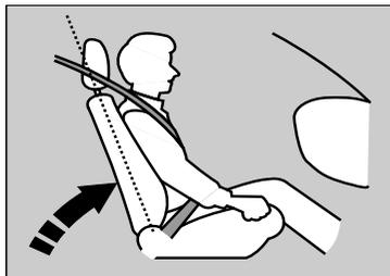
Regolare lo schienale del sedile lato guida in posizione perpendicolare al sedile, assicurandosi che vi sia spazio sufficiente tra il torace e il coperchio dell'airbag al centro del volante.
