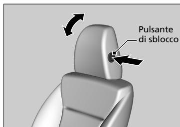
**Per inclinare il poggiatesta:** Farlo ruotare premendo contemporaneamente il pulsante di sblocco.
