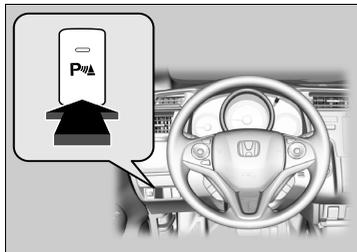
Con il commutatore di accensione su ACCENSIONE **II**\*1, premere il pulsante sistema sensori di parcheggio per attivare o disattivare il sistema. Quando il sistema è attivo, la spia nel pulsante si accende.
