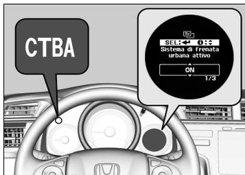
È possibile attivare e disattivare il sistema usando il display multi-informazioni.
