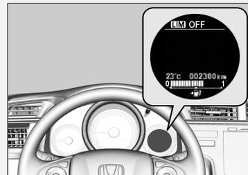
Se durante l'uso del limitatore di velocità regolabile si rileva un problema, viene emesso un segnale acustico e **OFF** si accende. Il limitatore di velocità regolabile viene disattivato.
