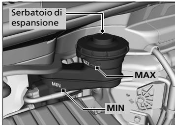
Il livello del liquido deve essere compreso tra le tacche **MIN** e **MAX** poste sul lato del serbatoio di riserva.
