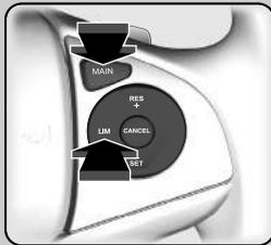
Se si accende una spia diversa, premere il pulsante **LIM** per passare al limitatore di velocità regolabile.
