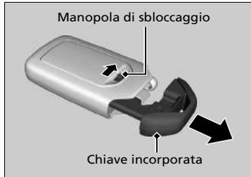
La chiave incorporata può essere utilizzata per bloccare/sbloccare le portiere quando la batteria del comando a distanza è scarica e la chiusura/apertura centralizzata è disabilitata.
