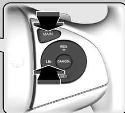
Se si accende una spia diversa, premere il pulsante **LIM** per passare al controllo velocità di crociera.
