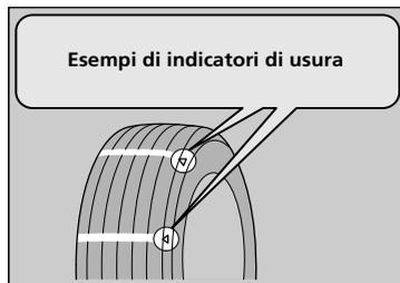
La scanalatura in cui si trova l'indicatore di usura del battistrada è meno profonda di 1,6 mm rispetto al resto della superficie dello pneumatico. Se il battistrada è usurato al punto tale che l'indicatore è visibile, sostituire lo pneumatico. **Pneumatici consumati hanno scarsa aderenza su strade bagnate.**
