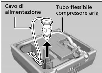
1. Estrarre il tubo flessibile e il cavo di alimentazione dalla parte posteriore del compressore aria.
