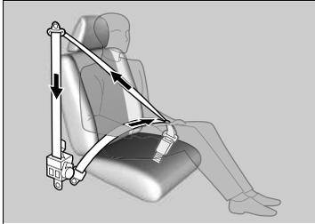
I tensionatori tendono automaticamente le cinture di sicurezza anteriori e quelle posteriori esterne durante una collisione frontale di moderata o grave entità, talvolta anche se la collisione non è così grave da attivare gli airbag anteriori.
