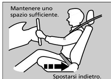
Regolare il sedile del conducente in una posizione il più lontano possibile che consenta tuttavia di mantenere il controllo completo del veicolo. Tale posizione deve consentire al conducente di sedersi in posizione eretta, rimanere ben appoggiato al sedile, premere i pedali senza doversi inclinare in avanti e afferrare il volante agevolmente. Il sedile del passeggero anteriore deve essere regolato in modo simile, in una posizione il più lontano possibile dall'airbag anteriore nella plancia.
