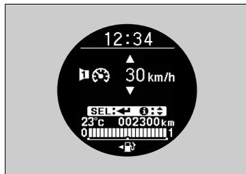
1. Premere il pulsante ▲①/▼ fino a quando il menu di impostazione dell'allarme velocità non viene visualizzato sul display, quindi premere il pulsante **SEL/RESET**.
