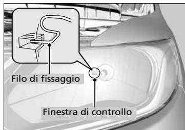
5. Reinstallare il filo di fissaggio. Agganciare l'estremità del filo alla manopola nella scanalatura.
