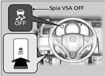
Questo pulsante si trova sul pannello di controllo lato guida. Per attivare e disattivare le funzioni secondarie del sistema VSA, premere e tenere premuto il pulsante fino a quando viene emesso un segnale acustico.
