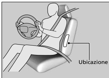
Gli airbag laterali sono alloggiati nel bordo esterno degli schienali del conducente e del passeggero.
