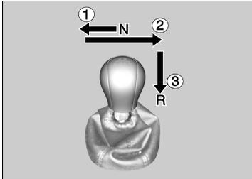
1. Premere il pedale della frizione, spostare la leva del cambio completamente verso sinistra e selezionare **R**.
