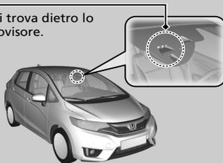
Il sistema si attiva quando la differenza di velocità tra il proprio veicolo e quello antistante rilevato è compresa tra circa 5 km/h e 32 km/h con un'elevata possibilità di collisione.
