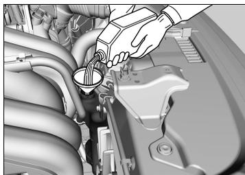
1. Controllare la quantità di liquido di raffreddamento nel serbatoio di riserva.
