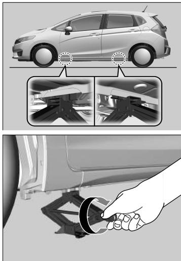
1. Posizionare il martinetto sotto al punto di sollevamento più vicino allo pneumatico da sostituire.
