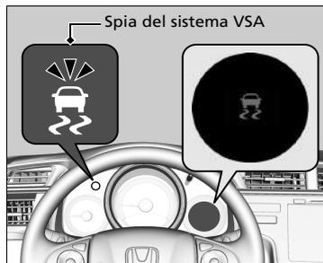
Quando il sistema VSA si attiva, il motore potrebbe non rispondere all'acceleratore, si potrebbe verificare un aumento della rumorosità nel sistema idraulico e la spia potrebbe lampeggiare.
