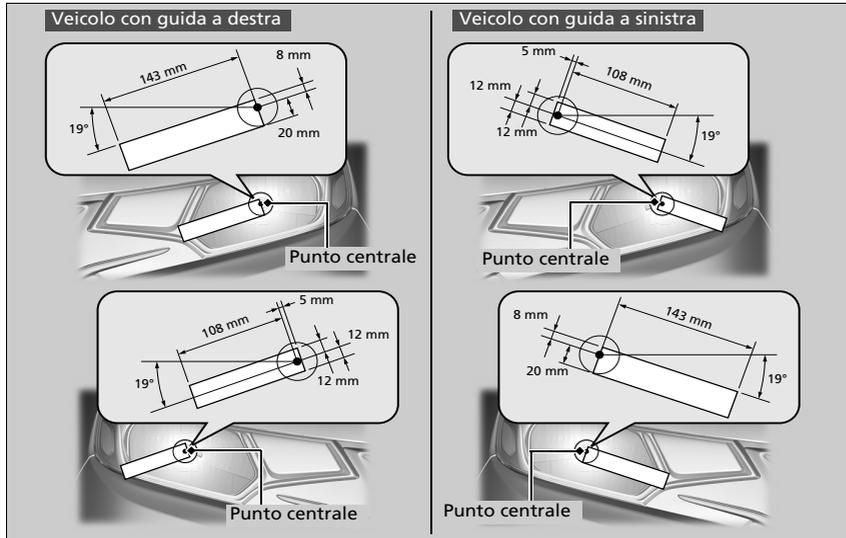
1. Preparare due rettangoli di nastro di mascheratura: uno largo 24 mm e lungo 113 mm, l'altro largo 28 mm e lungo 143 mm.
