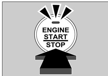
2. Premere il pedale del freno e il pedale della frizione (cambio manuale) e premere il pulsante **ENGINE START/STOP** entro 10 secondi dall'emissione del segnale acustico e dall'accensione della spia.
