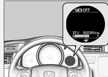
Se si rileva un problema nel sistema o nel sistema di riconoscimento della segnaletica stradale quando si utilizza il limitatore di velocità intelligente, viene emesso un segnale acustico e si accende la spia **OFF**. Il limitatore di velocità intelligente viene disattivato.
