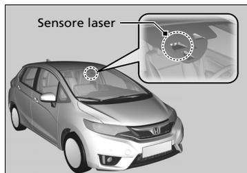
L'unità del sistema di frenata attiva in città, che incorpora il sensore laser, è situata nella parte posteriore dello specchietto retrovisore.
