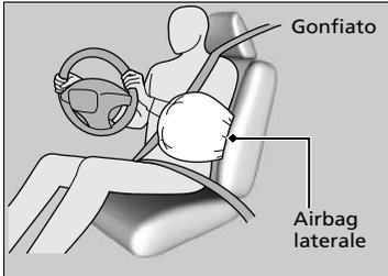
Quando i sensori rilevano un impatto laterale di moderata o grave entità, la centralina di comando invia un segnale all'airbag laterale sul lato dell'impatto per gonfiarlo immediatamente.
