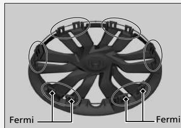
Allineare il contrassegno della valvola sul copriuota e la valvola dello pneumatico sulla ruota, quindi installare il copriuota.
