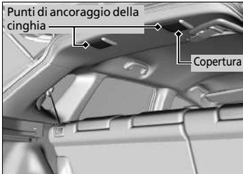
Nel rivestimento del padiglione sono presenti due punti di ancoraggio per i sedili posteriori esterni. I seggiolini di sicurezza per bambini montati con la cintura di sicurezza e dotati di una cinghia di ancoraggio possono utilizzare tale cinghia per garantire una maggiore sicurezza.
