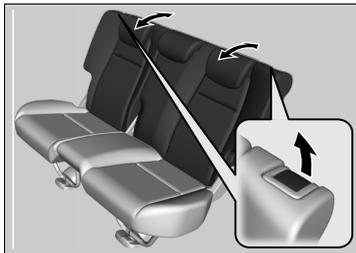
Tirare la leva sul lato destro per cambiare l'inclinazione della parte destra dello schienale e sul lato sinistro per la parte sinistra.
