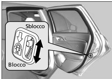
Spostare la leva della portiera posteriore nella posizione di bloccaggio e chiudere la portiera.
