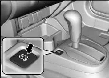
Premere questo pulsante per disattivare il sistema di arresto automatico del motore al minimo. Il sistema di arresto automatico del motore al minimo viene disattivato.
