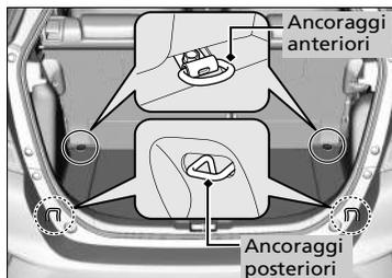
I punti di ancoraggio sul pianale del bagagliaio possono essere utilizzati per installare una rete per il fissaggio degli oggetti.
