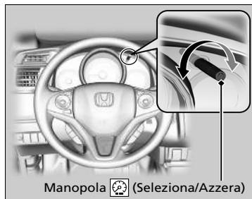
Con il commutatore di accensione su ACCENSIONE **II**\*1, è possibile utilizzare la manopola (Seleziona/Azzerà) per regolare la luminosità del quadro strumenti.
