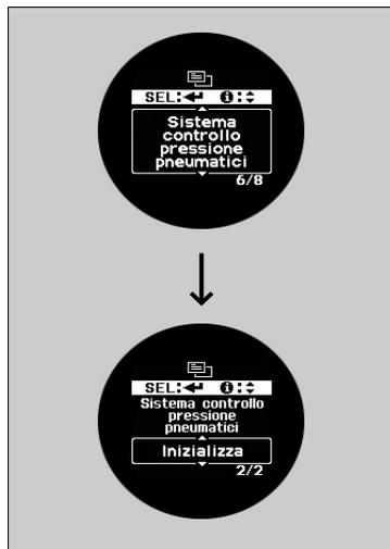
È possibile eseguire la taratura del sistema mediante le funzioni personalizzate sul display multi-informazioni.
