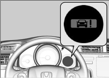
Quando una possibile collisione diventa quasi inevitabile, viene emesso un segnale acustico, l'avvertenza CTBA lampeggia sul display multi-informazioni e viene effettuata una frenata decisa. La frenata automatica con il sistema attivato viene annullata dopo l'arresto completo del veicolo. Azionare i freni di conseguenza. Dopo l'arresto del veicolo, sul display multi-informazioni viene visualizzato un simbolo indicante l'attivazione del sistema.
