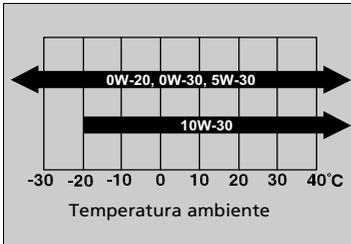
Utilizzare un olio motore Honda originale o un altro olio motore commerciale di viscosità SAE adeguato per la temperatura ambiente, come indicato.
