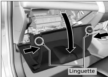
2. Disinserire le due linguette premendo ciascun pannello laterale.
