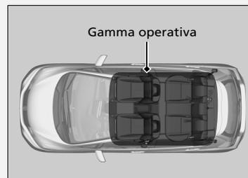
È possibile avviare il motore quando il comando a distanza si trova all'interno del veicolo.
