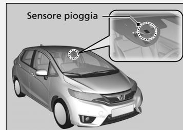
Non portare la leva tergicristalli su **AUTO** quando si pulisce il parabrezza o durante gli spostamenti all'interno di un autolavaggio. Se la leva tergicristalli si trova su **AUTO**, e il commutatore di accensione è su ACCENSIONE **II**<sup>\*1</sup>, il sensore pioggia potrebbe rispondere al movimento delle mani o ai liquidi di lavaggio e i tergicristalli potrebbero azionarsi automaticamente.
