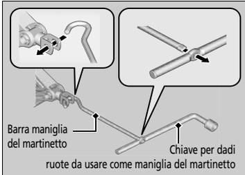
3. Sollevare il veicolo tramite la barra e la maniglia del martinetto, fino a quando lo pneumatico non è sollevato da terra.
