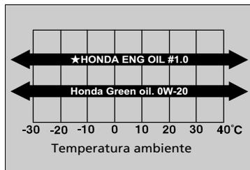
Utilizzare un olio motore commerciale con viscosità adeguata alla temperatura ambiente come mostrato.
