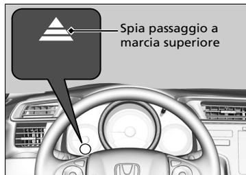
Si accende quando il veicolo è in modalità cambio manuale a 7 velocità per indicare un cambio marcia appropriato per mantenere lo stile di guida più efficiente in termini di consumo di carburante.
