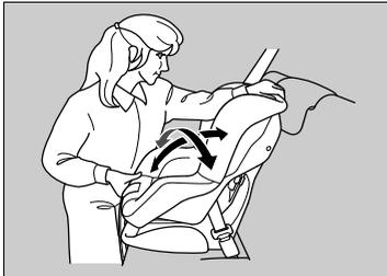
5. Spingere la linguetta verso il basso. Disporre la parte superiore della cintura nella fessura sul lato del seggiolino.
