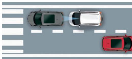
**3:** Se anche ora non intervieni e la collisione è imminente, il Sistema attivo di frenata in città applica automaticamente una frenata di emergenza per ridurre il più possibile la velocità. In buone condizioni di guida, potrebbe evitare del tutto un incidente.
