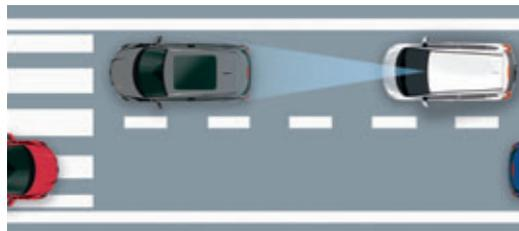
**1:** Mentre si guida in città a una velocità compresa tra 5 e 32 km/h, il sistema è in grado di monitorare la distanza tra te e l'auto che precede, dandoti la possibilità di evitare una collisione.
