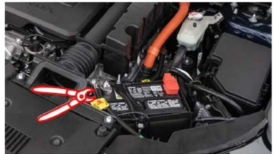
**2. Disattivazione del sistema ad alta tensione nel vano motore**
