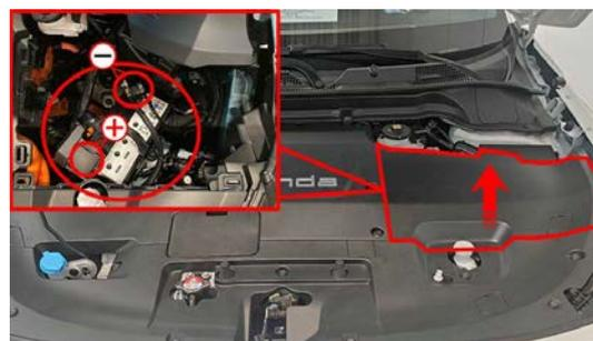
**2. Disattivazione del sistema ad alta tensione nel vano motore**
