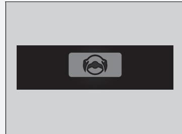
Se il conducente non afferra il volante dopo la visualizzazione ripetuta dell'avviso suddetto, si attiva un cicalino di allarme e il sistema Traffic Jam Assist viene annullato.
