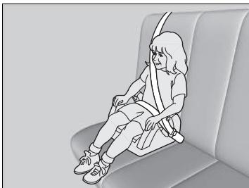
Se non è possibile usare correttamente la cintura di sicurezza a tre punti di ancoraggio, far sedere il bambino su un cuscino di rialzo sul sedile posteriore. Per la sicurezza del bambino, controllare che l'età e il peso del bambino corrispondano alle raccomandazioni del produttore del cuscino di rialzo.
