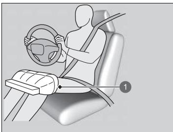
Quando l'airbag anteriore lato conducente si gonfia, si gonfia anche l'airbag per le ginocchia.
