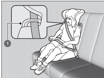
Per alcuni cuscini di rialzo per bambini è disponibile uno schienale. Montare lo schienale sul cuscino di rialzo per bambini e regolarlo sul sedile del veicolo in base alle istruzioni del produttore del cuscino. Assicurarsi che la cintura di sicurezza sia disposta correttamente attraverso la guida e che il bordo dello schienale e la cintura non tocchino e passino sul collo del bambino.
