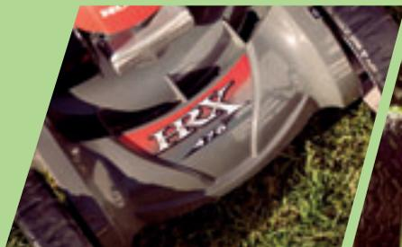
**Il Polystrong e lo Xenoy** del piatto di taglio della gamma HRX sono entrambi materiali in polimero particolarmente resistenti ai raggi UV, alla corrosione e alle ammaccature.
