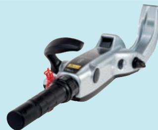
Disponibile come optional, la barra di comando multifunzione per il modello BF40E/BF40D, include tutto ciò di cui avete bisogno: selettore della funzione di regolazione assetto-inclinazione, leva di inversione del cambio, regolazione della barra e perfino un display indicante lo stato di funzionamento del motore.
