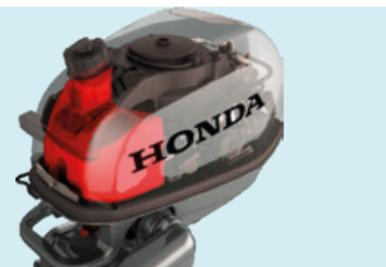
I nuovi motori della gamma BF4/5/6 sono stati progettati specificamente per integrare un serbatoio carburante di maggiori dimensioni (1,5 l).
