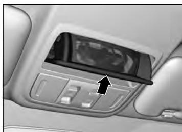
Per aprire il portaocchiali, esercitare una pressione sull'incavo e rilasciare. Per chiuderlo, premerlo nuovamente finché non scatta in posizione.
