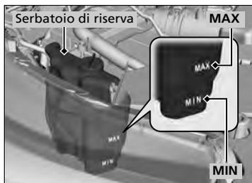
1. Controllare la quantità di liquido di raffreddamento nel serbatoio di riserva.
