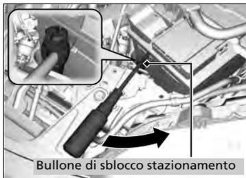
4. Inserire un cacciavite nel foro dell'albero del bullone di sblocco stazionamento. Ruotare il cacciavite in senso antiorario per allentare il bullone di sblocco stazionamento.
