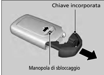
La chiave incorporata può essere utilizzata per bloccare le portiere quando la batteria del comando a distanza è scarica e la chiusura/apertura centralizzata è disabilitata. Per rimuovere la chiave incorporata, estrarla facendo scorrere contemporaneamente la manopola di sbloccaggio. Per reinserire la chiave incorporata, spingerla nel comando a distanza finché non si avverte uno scatto.
