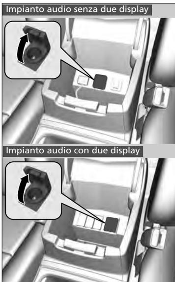
■ **Presa di alimentazione accessori nel vano console centrale**
