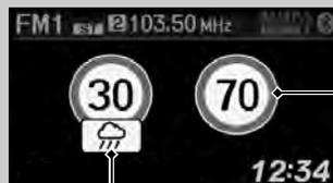
Segnale aggiuntivo del limite di velocità basato sulle condizioni atmosferiche<sup>\*2</sup>
