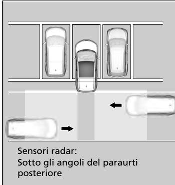
Quando un veicolo si avvicina da un angolo posteriore, il monitor per vettura in arrivo lateralmente attiva un cicalino e visualizza un avviso per avvertire il conducente.
