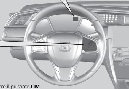
Se si accende una spia diversa, premere il pulsante **LIM** per passare al limitatore di velocità regolabile.
