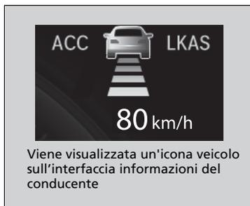
Quando un veicolo che precede a una velocità inferiore alla velocità impostata vi taglia la strada e viene rilevato dal radar e dalla telecamera, il proprio veicolo inizia a rallentare.
