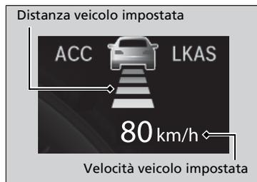
Quando l'ACC con LSF inizia a funzionare, sull'interfaccia informazioni del conducente vengono visualizzati l'icona veicolo, le barre della distanza e la velocità impostata.
