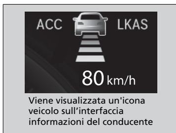
Quando un veicolo che precede a una velocità inferiore alla velocità impostata vi taglia la strada e viene rilevato dal radar e dalla telecamera, il proprio veicolo inizia a rallentare.
