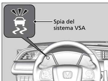
Quando il sistema VSA si attiva, il motore potrebbe non rispondere all'acceleratore, si potrebbe verificare un aumento della rumorosità nel sistema idraulico e la spia potrebbe lampeggiare.
