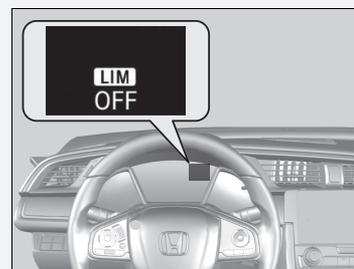
Se durante l'uso del limitatore di velocità regolabile si rileva un problema, viene emesso un segnale acustico e **OFF** si accende. Il limitatore di velocità regolabile viene disattivato.
