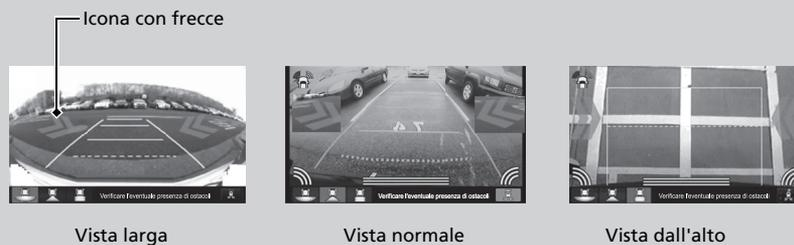
Sullo schermo audio/informazioni viene visualizzata un'icona con delle frecce sul lato del veicolo in avvicinamento.
