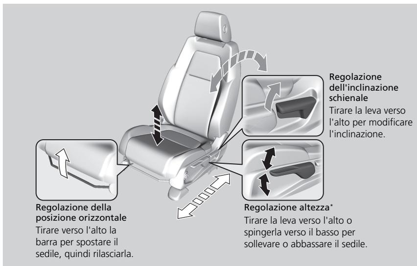
Una volta regolato correttamente il sedile, farlo oscillare avanti e indietro per assicurarsi che sia bloccato in posizione.
