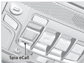
Se il veicolo rimane coinvolto in un incidente, la centralina del sistema SRS installata sulla vettura cercherà di connettersi con un operatore di un centro di raccolta delle chiamate di emergenza (PSAP). Una volta stabilito il collegamento con un operatore PSAP, verranno inviate varie informazioni sul veicolo all'operatore stesso. Queste informazioni comprendono:
