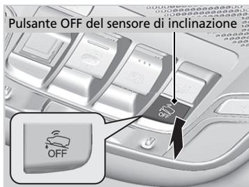
Per disattivare il sistema del sensore di inclinazione premere il pulsante OFF del sensore a ultrasuoni dopo aver impostato la modalità di alimentazione su ACCESSORI o su VEICOLO SPENTO (BLOCCO).
