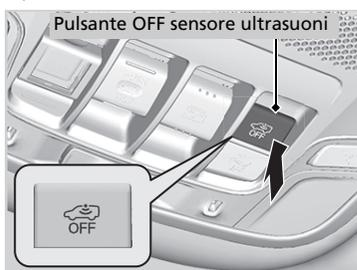
Per disattivare il sistema del sensore a ultrasuoni premere il pulsante OFF del sensore a ultrasuoni dopo aver impostato la modalità di alimentazione su ACCESSORI o su VEICOLO SPENTO (BLOCCO).
