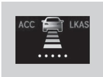
Anche il proprio veicolo si arresta automaticamente. Sull'interfaccia informazioni del conducente viene visualizzato il messaggio **•••••**.
