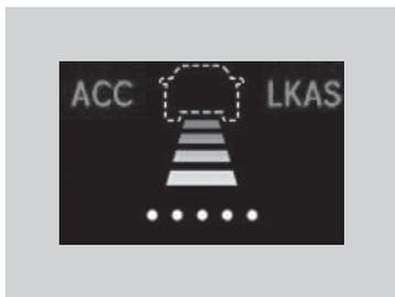
Se prima di riprendere la guida non sono presenti altri veicoli antistanti, premere il pedale dell'acceleratore e l'ACC con LSF riprenderà a funzionare alla velocità impostata precedentemente.
