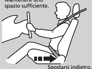
Regolare il sedile lato guida in una posizione il più lontano possibile che consenta tuttavia di mantenere il controllo completo del veicolo. Tale posizione deve consentire al conducente di sedersi in posizione eretta, rimanere ben appoggiato al sedile, premere i pedali senza doversi inclinare in avanti e afferrare il volante agevolmente. Il sedile del passeggero anteriore deve essere regolato in modo simile, in una posizione il più lontano possibile dall'airbag anteriore nella plancia.
