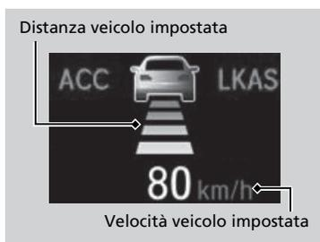
Quando l'ACC con LSF inizia a funzionare, sull'interfaccia informazioni del conducente vengono visualizzate l'icona veicolo, le barre della distanza e la velocità impostata.
