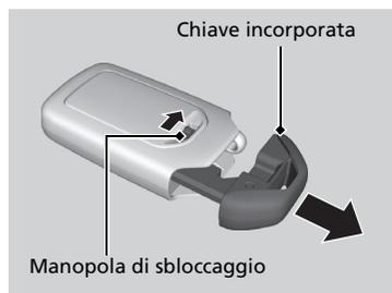
La chiave incorporata può essere utilizzata per bloccare/sbloccare le portiere quando la batteria del telecomando è scarica e la chiusura/apertura centralizzata è disabilitata. Per rimuovere la chiave incorporata, far scorrere la manopola di sbloccaggio, quindi estrarre la chiave. Per reinserire la chiave incorporata, spingerla nel comando a distanza finché non si avverte uno scatto.
