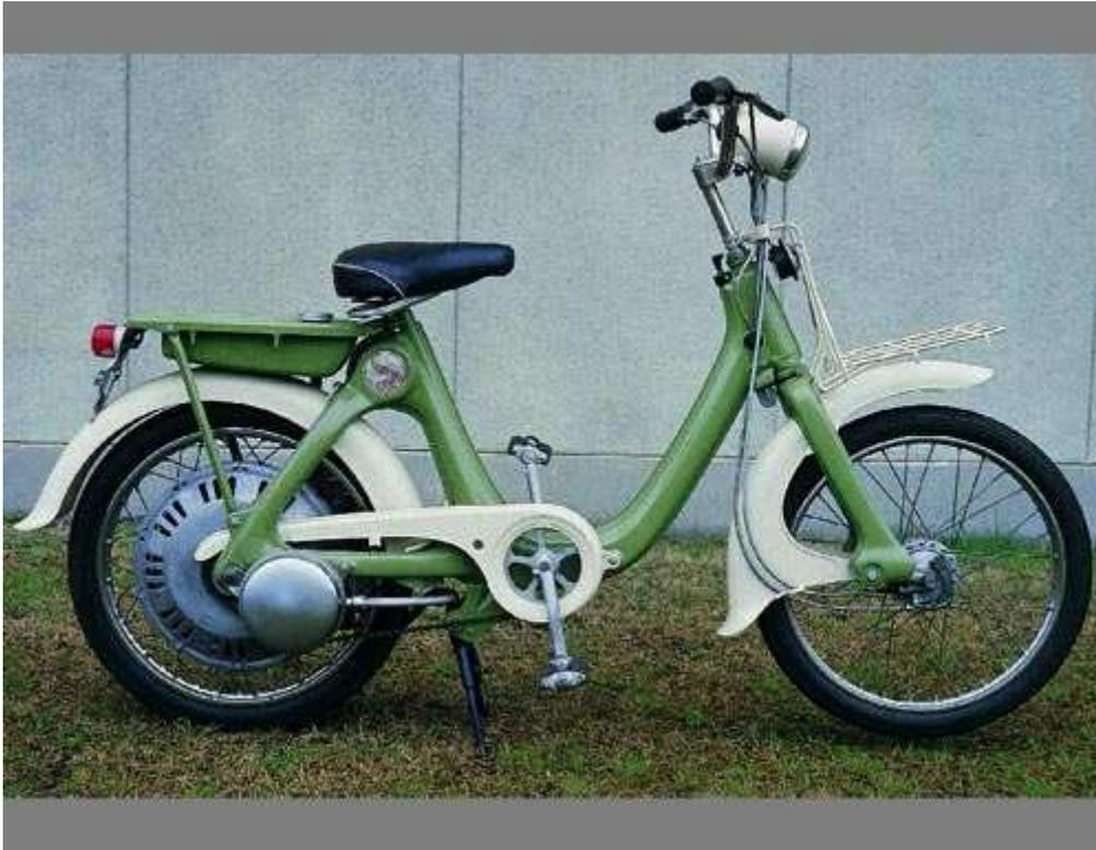
Il motore dentro una ruota
