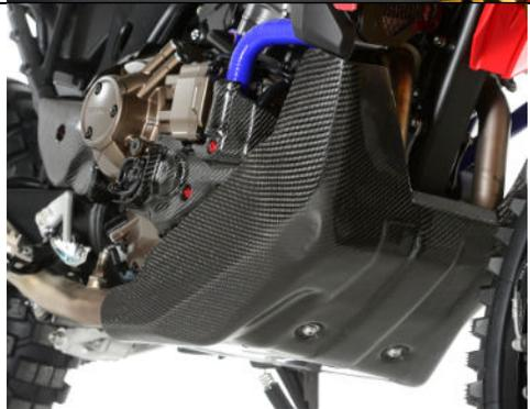
Tutti i **tappi** motore e controllo fase sono in alluminio anodizzato ricavati dal pieno così come il tappo della pompa freno anteriore.
