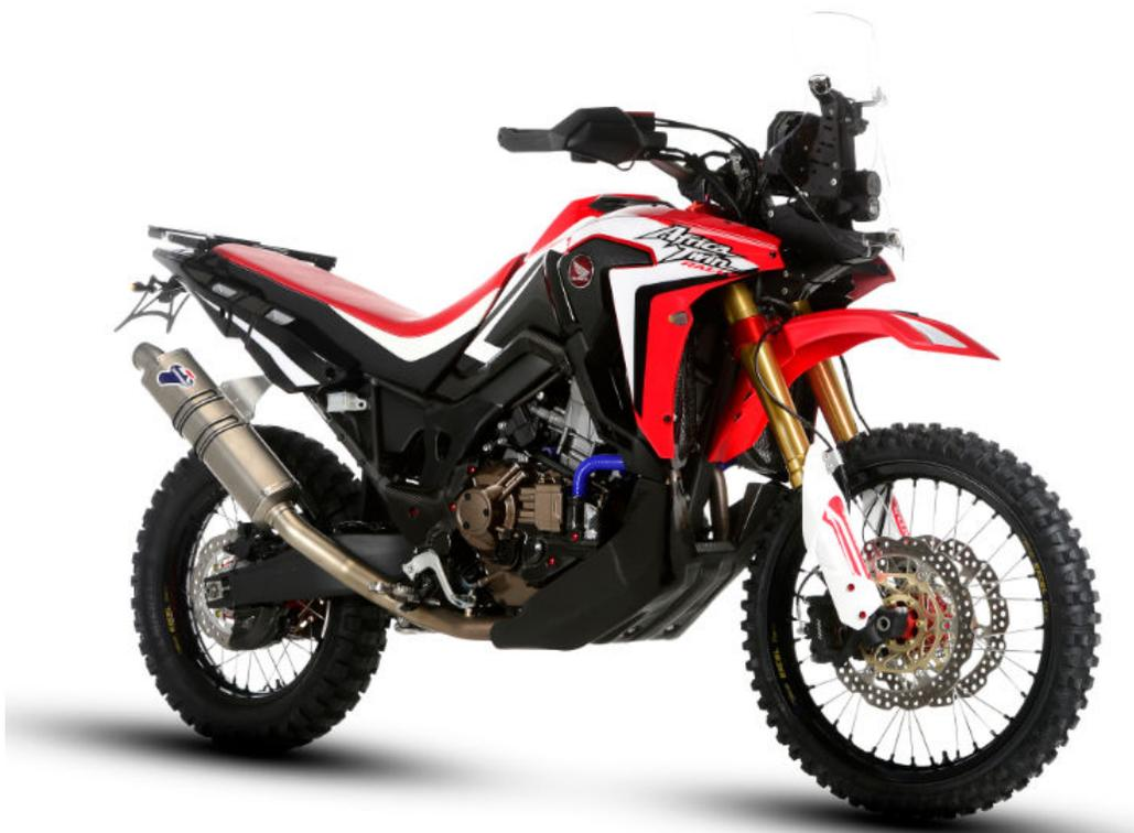
L'Africa Twin Rally 2017 è un modello regolarmente omologato per la circolazione su strada, disponibile sia nella versione con cambio manuale che nella versione con cambio sequenziale a doppia frizione DCT (Dual Clutch Transmission). Le emissioni allo scarico rispettano i limiti imposti dall'omologazione Euro4.
