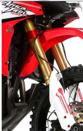
**Ammortizzatore** con nuova molla e nuova taratura idraulica per adattarsi perfettamente alla guida in fuoristrada. Rimane invariato il sistema di precarico originale che è ora dotato di manopola in alluminio anodizzato ricavato dal pieno.
