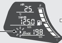
Display autonomia di percorrenza e indicatore di pressione pneumatici
