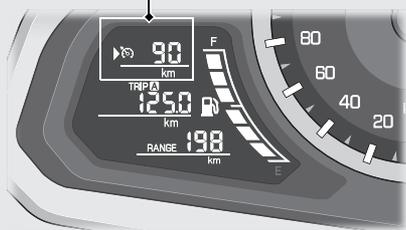
Ogni tocco rapido (breve pressione e rilascio) da entrambi i lati cambia la velocità di 1 km/h o 1 mph (a seconda dell'unità impostata per l'indicatore del chilometraggio).
