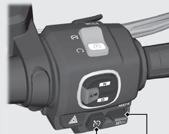
Leva di controllo velocità di crociera
