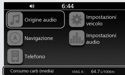
**Intervallo di visualizzazione:** da 0.1 a 99.9 L/100 km, km/L, MPG (Versione II E/III E) o mile/L (Versione II E/III E)
