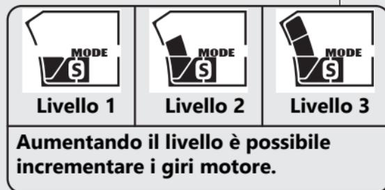
Il livello selezionato viene mantenuto anche quando il commutatore di accensione viene portato in posizione **O** (Off) oppure se la trasmissione è in modalità diversa dalla modalità S.
