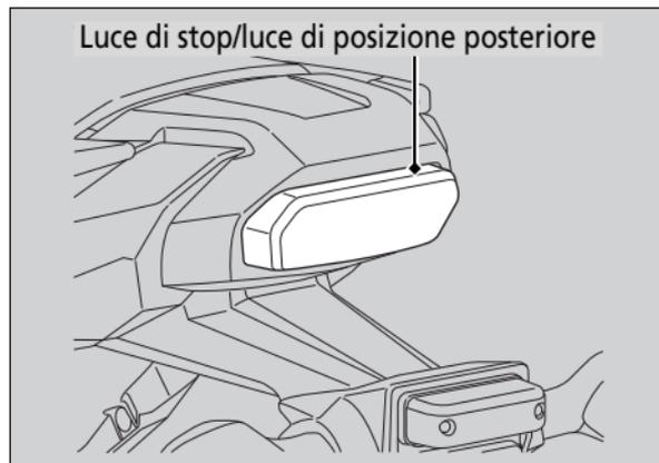
La luce di stop e la luce di posizione posteriore utilizzano diversi LED. Se un LED non si accende, rivolgersi al proprio concessionario per la riparazione.
