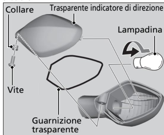
4. Installare la nuova lampadina e i componenti eseguendo in ordine inverso la procedura utilizzata per la rimozione.
