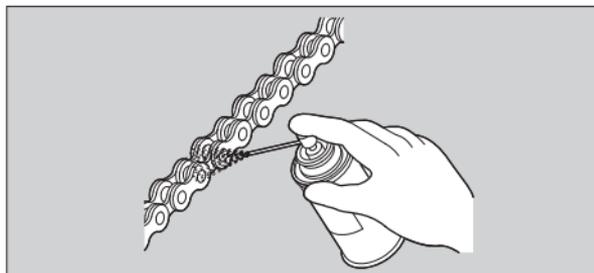
Non utilizzare pulitori a vapore, aspiratori ad alta pressione, spazzole metalliche, solventi volatili quali carburante e benzene, detergenti abrasivi, detergenti per catene o lubrificanti NON specifici per catene con O-ring, poiché potrebbero danneggiare le guarnizioni degli O-ring di gomma. Non versare il lubrificante sui freni o sui pneumatici. Non utilizzare quantità eccessive di lubrificante per catene, per evitare di spruzzarlo sui propri indumenti e sulla motocicletta.
