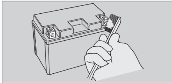
4. Dopo la pulizia, reinstallare la batteria.
