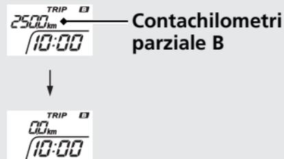
Inoltre, il contachilometri parziale, il consumo chilometrico medio e il consumo di carburante verranno azzerati automaticamente quando si rifornisce la motocicletta di una quantità di carburante superiore alla riserva e si percorrono 0,1 km. La modalità di azzeramento automatico può essere attivata o disattivata facendo rifornimento. ➡ P. 27
