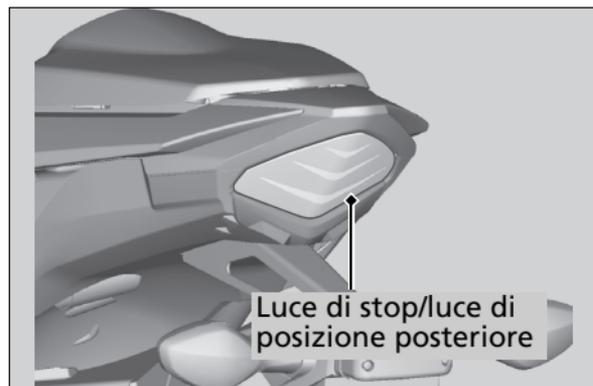
La luce di stop e la luce di posizione posteriore utilizzano diversi LED.
