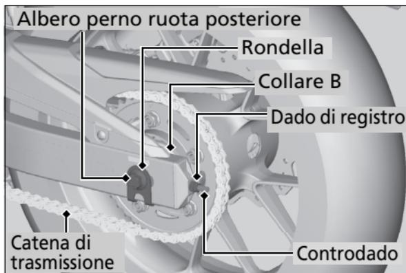
6. Rimuovere l'albero del perno della ruota posteriore, la rondella, la staffa della pinza del freno, la ruota posteriore e i collari laterali.
