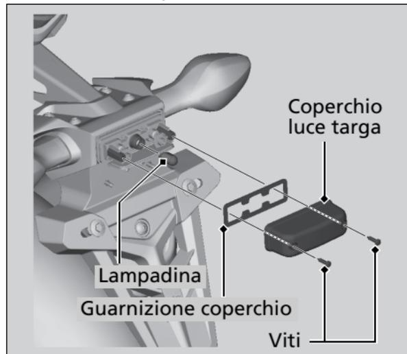
3. Installare la nuova lampadina e i componenti eseguendo in ordine inverso la procedura utilizzata per la rimozione.
