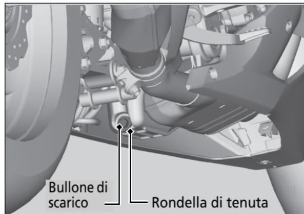
5. Per scaricare l'olio, rimuovere il tappo del bocchettone di riempimento olio, il bullone di scarico e la rondella di tenuta.
