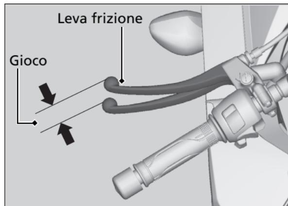
Controllare se il cavo della frizione è attorcigliato o presenta segni di usura. Se necessario, farlo sostituire dal concessionario.
