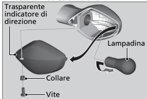
4. Installare la nuova lampadina e i componenti eseguendo in ordine inverso la procedura utilizzata per la rimozione.
