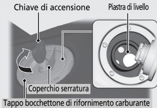
Evitare di rifornire di carburante oltre la piastra di livello.
