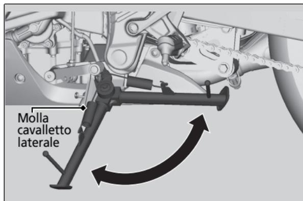
1. Controllare che il cavalletto laterale funzioni regolarmente. Se il cavalletto laterale è duro o cigola, pulire la zona intorno al perno e lubrificare il bullone del perno con del grasso pulito.
