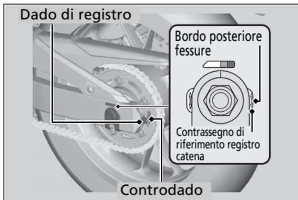
5. Ruotare i dadi di registro di un uguale numero di giri fino ad ottenere il lasco corretto della catena di trasmissione. Per serrare la catena, ruotare i dadi di registro in senso antiorario. Ruotare i dadi di registro in senso antiorario per ottenere un lasco maggiore.
