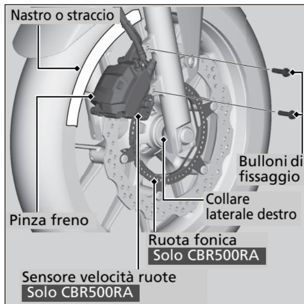
4. Allentare il bullone di serraggio del perno e l'albero del perno della ruota anteriore.
