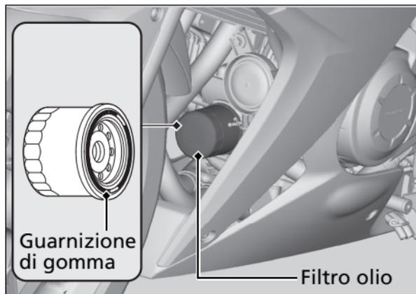
7. Applicare un sottile strato di olio motore sulla guarnizione di gomma del nuovo filtro olio.
