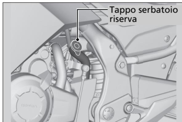
**Sostituzione del liquido di raffreddamento**
