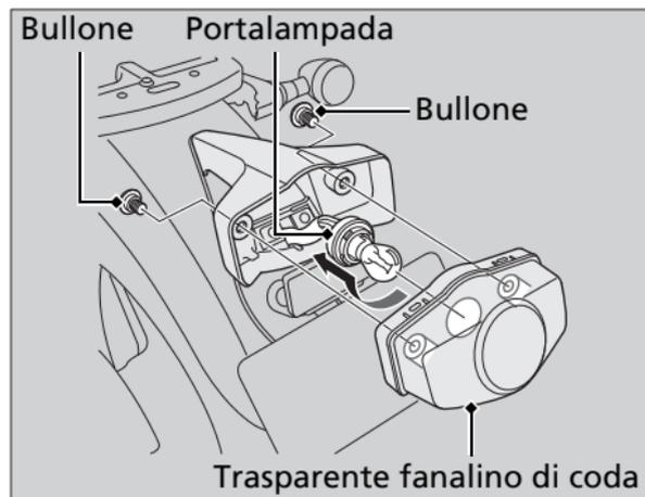
1. Rimuovere il trasparente del fanalino di coda rimuovendo i bulloni.
