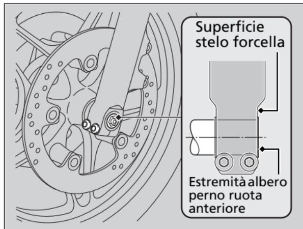
4. Serrare i bulloni di serraggio lato sinistro del perno della ruota per bloccare il perno della ruota.
