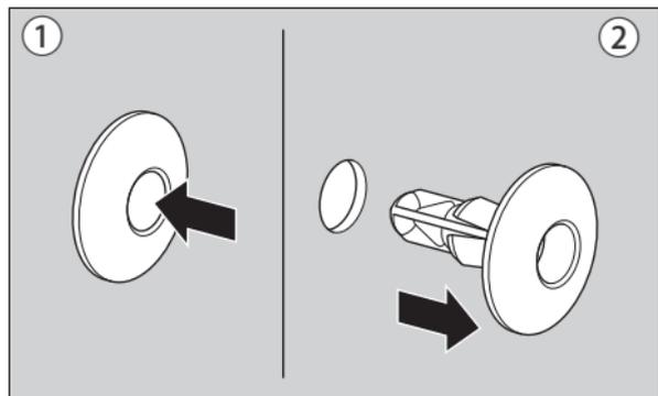
1. Premere verso il basso in corrispondenza del perno centrale per sganciare il dispositivo di bloccaggio.
