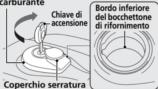
Non rifornire di carburante oltre il bordo inferiore del bocchettone di rifornimento.
