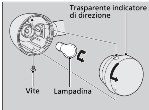
4. Installare una nuova lampadina e i componenti nell'ordine inverso rispetto alla rimozione.
