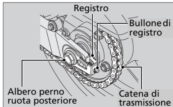
6. Rimuovere la staffa della pinza del freno, la ruota posteriore e i collari laterali.
