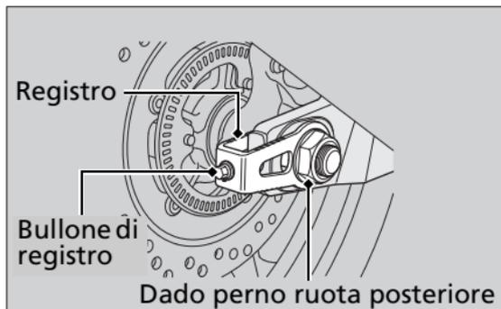
4. Rimuovere la catena di trasmissione dall'ingranaggio della ruota posteriore spingendo la ruota posteriore in avanti.
