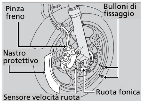
3. Sul lato destro, rimuovere i bulloni di fissaggio e la pinza del freno.
