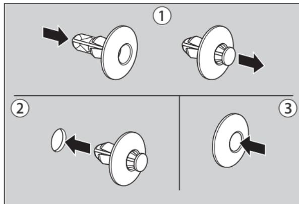
1. Premere la parte inferiore del perno centrale.
