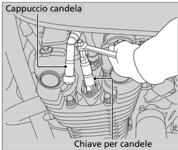
4. Controllare se gli elettrodi e la parte centrale in porcellana presentano tracce di sporco, erosione o imbrattamento da carbonio.
