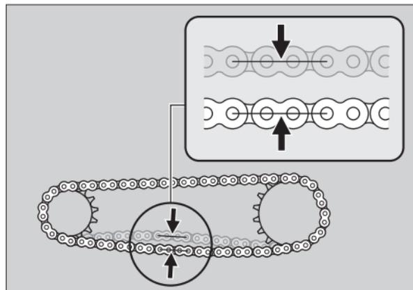
4. Ruotare la ruota posteriore e verificare che la catena si muova in modo regolare.
