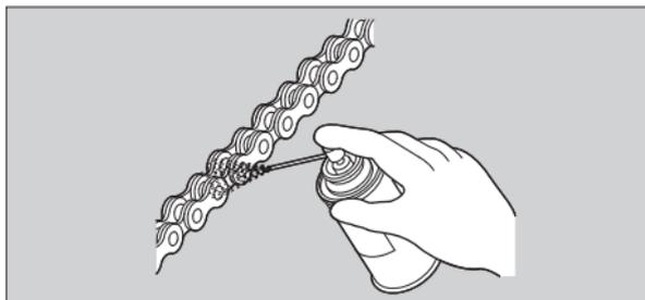
Non utilizzare pulitori a vapore, aspiratori ad alta pressione, spazzole metalliche, solventi volatili quali carburante e benzene, detergenti abrasivi, detergenti per catene o lubrificanti NON specifici per catene con O-ring, poiché potrebbero danneggiare le guarnizioni degli O-ring di gomma. Non versare il lubrificante sui freni o sui pneumatici.
