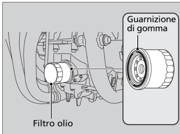
7. Applicare un sottile strato di olio motore sulla guarnizione di gomma del nuovo filtro olio.
