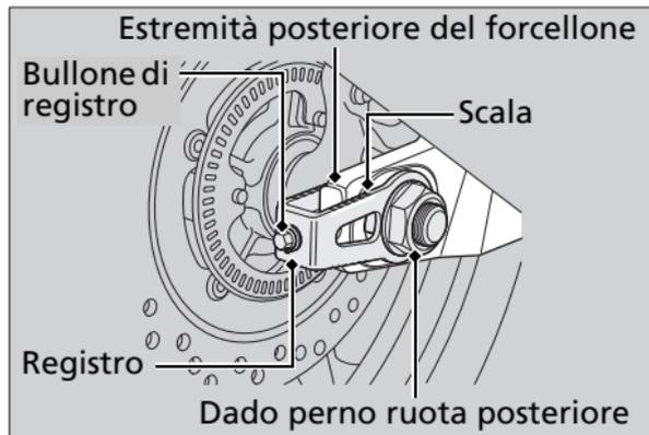
4. Ruotare i bulloni di registro di un uguale numero di giri fino ad ottenere il lasco corretto della catena di trasmissione. Ruotare i bulloni di regolazione in senso antiorario per serrare la catena, o in senso orario per allentarla. Regolare il lasco della catena in un punto a metà tra il pignone e la corona della ruota posteriore. Controllare il lasco della catena di trasmissione. ► P. 73
