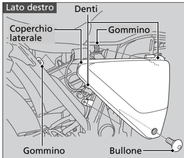
La sostituzione delle carenature laterali destra e sinistra può essere eseguita nello stesso modo.
