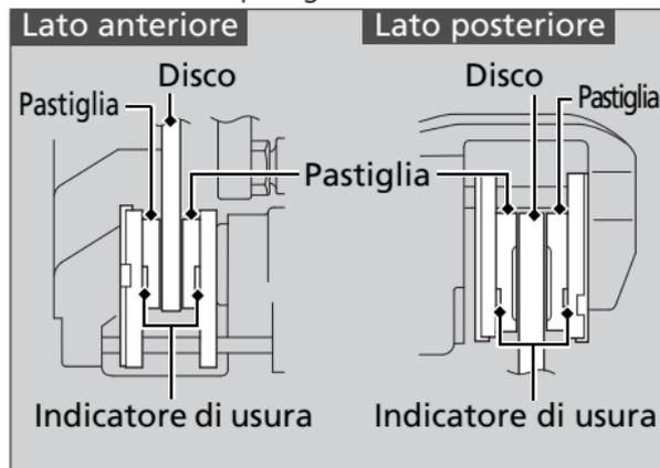
1. **Lato anteriore** Controllare le pastiglie del freno dalla parte sottostante la pinza del freno. ► Controllare sempre le pinze sinistra e destra.
