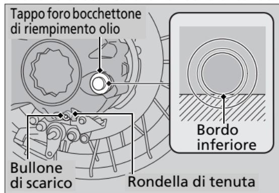
5. Installare una nuova rondella di tenuta sul bullone di scarico. Serrare il bullone di scarico.
