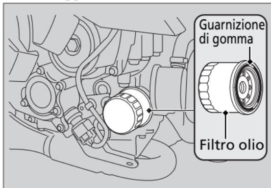
8. Applicare un sottile strato di olio motore sulla guarnizione di gomma del nuovo filtro olio.
