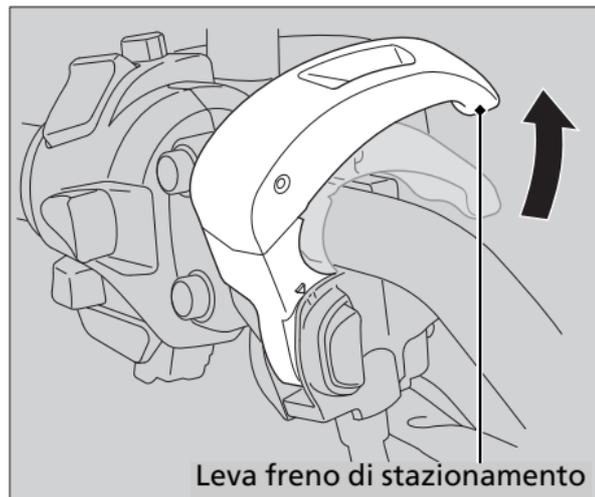
Appoggiare la motocicletta su una superficie solida e in piano. Spegnerne il motore e spingere la motocicletta mentre si aziona la leva del freno di stazionamento per verificare l'efficacia del freno di stazionamento.
