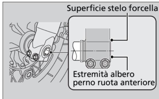
4. Serrare i bulloni di serraggio lato sinistro del perno della ruota per bloccare il perno della ruota.
