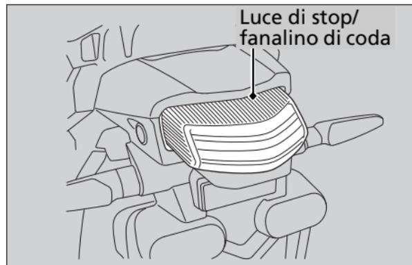
La luce di stop e il fanalino di coda utilizzano diversi LED.
