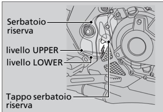
Se il livello del liquido di raffreddamento diminuisce notevolmente o il serbatoio della riserva è vuoto, è probabile che ci siano importanti perdite. Fare controllare la motocicletta presso il concessionario.
