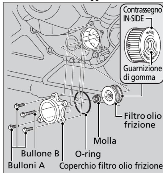
3. Installare il nuovo filtro olio frizione con la guarnizione di gomma rivolta all'interno verso il motore. È possibile identificare il contrassegno "IN-SIDE" sul corpo del filtro olio frizione, vicino alla guarnizione.
