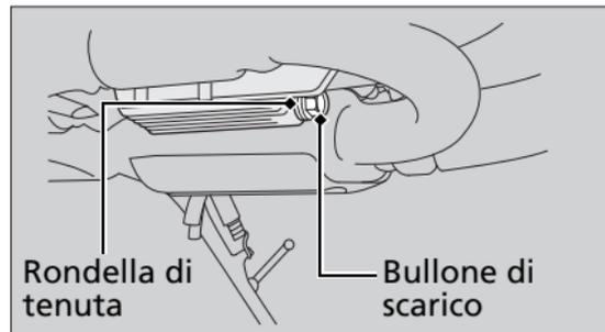
6. Rimuovere il pannello paracalore destro del motore e la carenatura inferiore destra. ► P. 65
