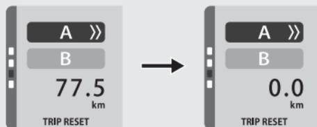
Inoltre, il contachilometri parziale A, il consumo di carburante del contachilometri parziale A e il consumo chilometrico medio del contachilometri parziale A possono azzerarsi automaticamente quando l'indicatore livello carburante aumenta di oltre 2 segmenti dopo il rifornimento.
