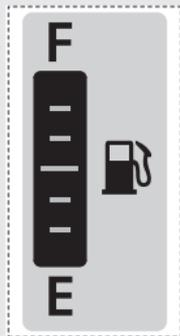
Quando il carburante restante è meno di circa 3,8 L, la visualizzazione cambia automaticamente da CARBURANTE a AUTONOMIA. ➡ P.29
