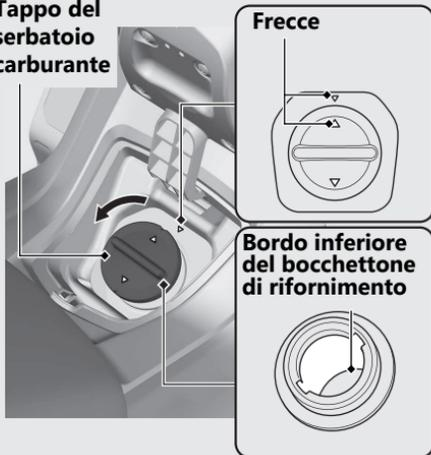
Non rifornire di carburante oltre il bordo inferiore del bocchettone di rifornimento.
