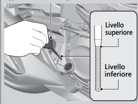
Olio motore ► Aggiunta di olio motore
