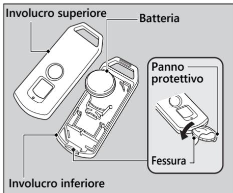
2. Sostituire la batteria usata con una batteria nuova con il lato negativo  $\ominus$  rivolto verso l'alto.
