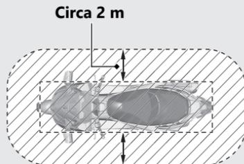
Chiunque può sbloccare il commutatore di accensione e avviare il motore se la Honda SMART Key è all'interno del raggio d'azione del veicolo, anche se si è dietro una parete o una finestra. Se ci si allontana dal veicolo ma la Honda SMART Key è ancora dentro il raggio d'azione, disattivare il sistema Honda SMART Key.
