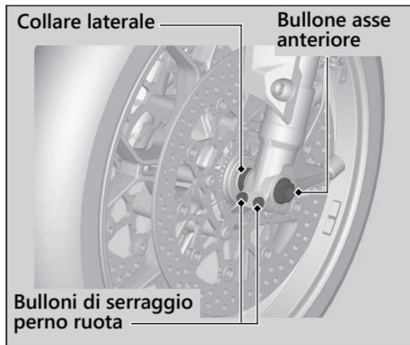
8. Allentare i bulloni di serraggio lato destro del perno della ruota.
