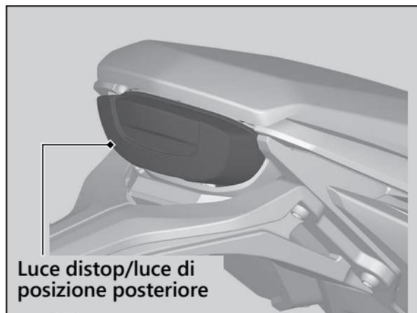
La luce di stop e la luce di posizione posteriore utilizzano diversi LED.
