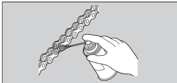
Non utilizzare pulitori a vapore, aspiratori ad alta pressione, spazzole metalliche, solventi volatili quali carburante e benzene, detergenti abrasivi, detergenti per catene o lubrificanti NON specifici per catene con O-ring, poiché potrebbero danneggiare le guarnizioni degli O-ring di gomma. Non versare il lubrificante sui freni o sugli pneumatici. Non utilizzare quantità eccessive di lubrificante per catene, per evitare di spruzzarlo sui propri indumenti e sulla motocicletta.
