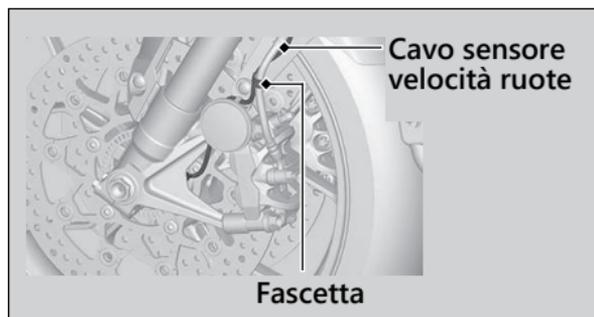
9. Installare la pinza destra del freno e serrare i nuovi bulloni di fissaggio.
