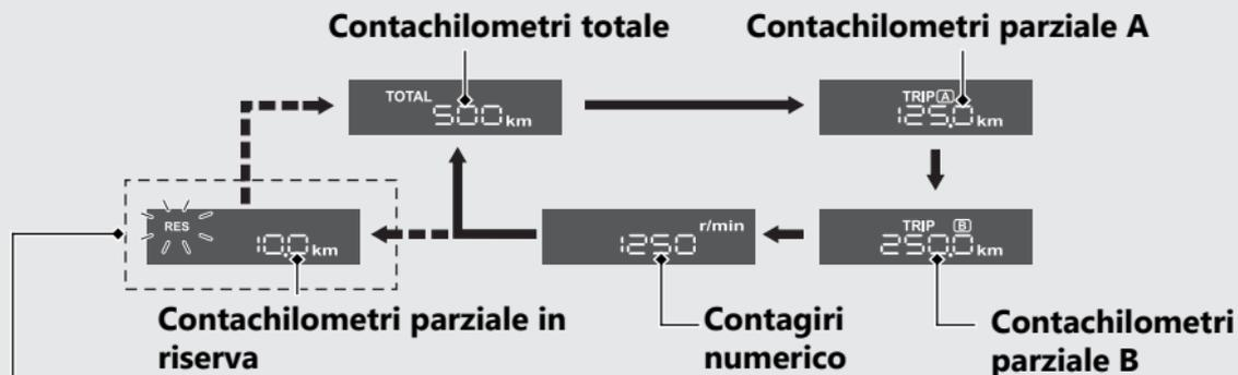
**Quando il 1° segmento (E) dell'indicatore livello carburante inizia a lampeggiare**
