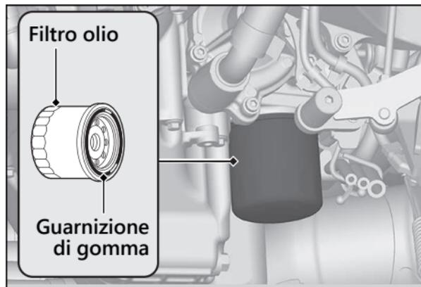
7. Applicare un sottile strato di olio motore sulla guarnizione di gomma del nuovo filtro olio.
