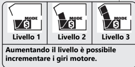
Il livello selezionato viene mantenuto anche quando il commutatore di accensione viene portato in posizione
