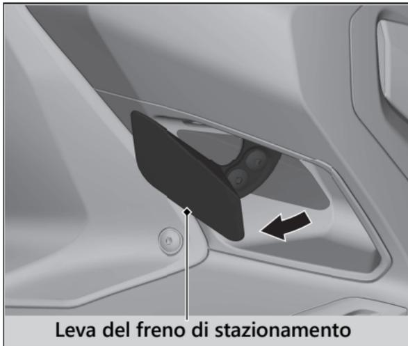
Appoggiare la motocicletta su una superficie solida e in piano. Arrestare il motore e spingere la motocicletta mentre si aziona la leva del freno di stazionamento per verificare l'efficacia del freno di stazionamento.
