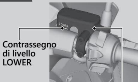
Serbatoio del liquido freno anteriore
