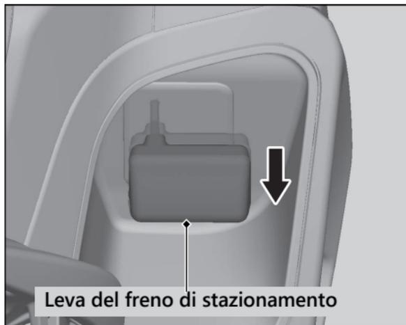
Appoggiare la motocicletta su una superficie solida e in piano. Arrestare il motore e spingere la motocicletta mentre si aziona la leva del freno di stazionamento per verificare l'efficacia del freno di stazionamento.
